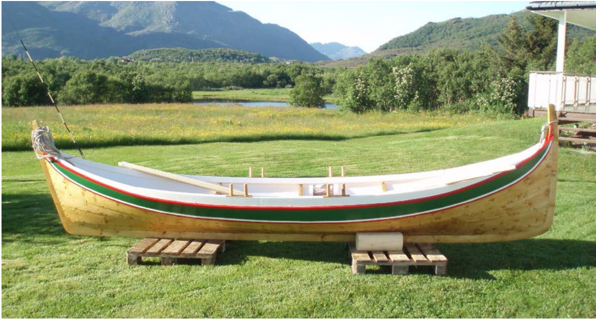
Nordlandsbåt av sitkagran bygd av Tore Kornbakk på Sortland med båtbord fra skogen til Tor Andersen i Bø og saget på Fjærvollsaga til Nils Erik Klaussen. Foto: Tor Andersen.
